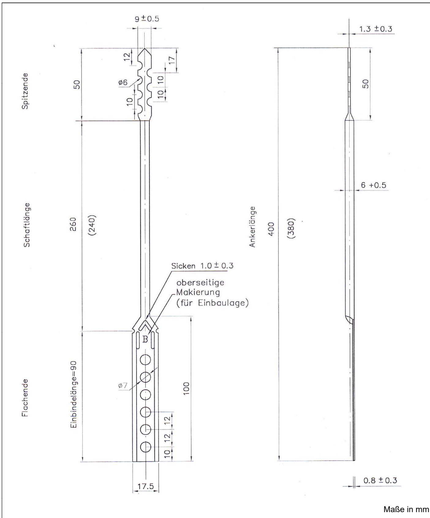
Multi-Luftschichtanker Plus für zweischaliges Mauerwerk
